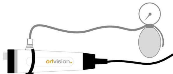
Imagen: 10 Conexión del comprobador de estanqueidad
