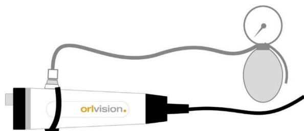
Figura: 10 Attacco del Leak Tester
